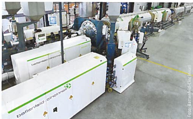
Sowohl die Einschneckenextruder der Serien Sol-Ex und Uni-Ex auch als auch die Green Pipe-Nachfolgeeinheit arbeiten besonders energieeffizient.
