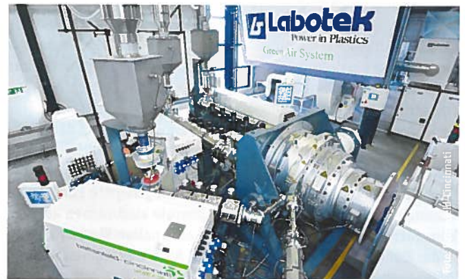
Die Luft aus dem Innenkühlsystem EAC des Rohrkopfes wird mit Hilfe des Drying Systems von Labotek zur Vorwärmung des Granulates verwendet.
