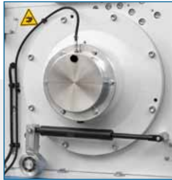
Öffnung des Siebhalters mit Gasdruckzylinder unterstützt
