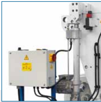
Öffnung des Fülltrichters mit motorisierter Winde
