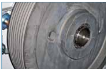
Expansionsstopfen zur Befestigung der Antriebsscheibe und des Schwungrads Standard-Riemenscheibe für erhöhte Schwungkraft
