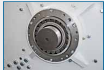
Pendelrollenlager mit Druckbuchsen, gusseiserne Aufnahmen
