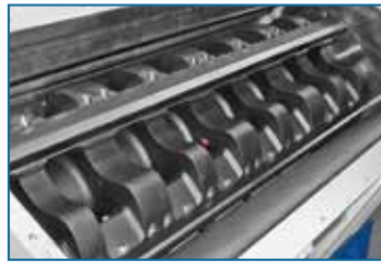
Scherschnitt bei 3- und 5-Blattroter
