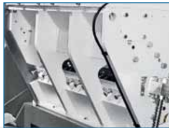
Zusammenbau der Mahlkammer mit erster verschleißfester Querstange
