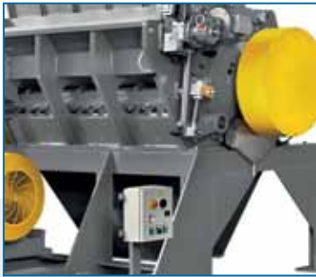
Öffnung des Fülltrichters mit motorisierter Winde Eingebaute Schalttafel
