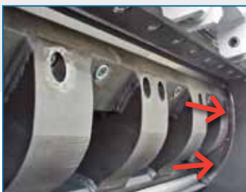
Mitlaufende Seitenscheiben, auf dem Rotor befestigt Feststehende Scheiben als Option
