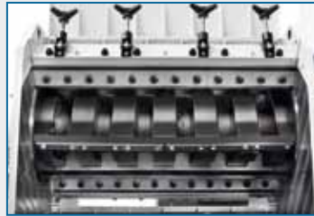
V-Schnitt bei 7-Blattroter
