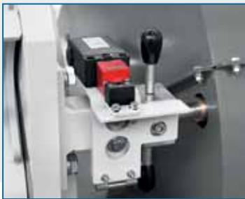
Arretierung des Rotors zu Wartungszwecken
