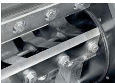
Mitlaufende Seitenscheiben, auf dem Motor befestigt; Stator- und Rotormesser an der Werkbank voreinstellbar
