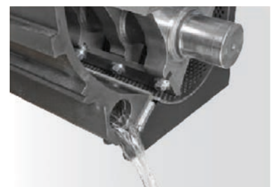
Wassergekühlte Kammer; Siebfläche entspricht ungefähr 50 % des Schneidkreises
