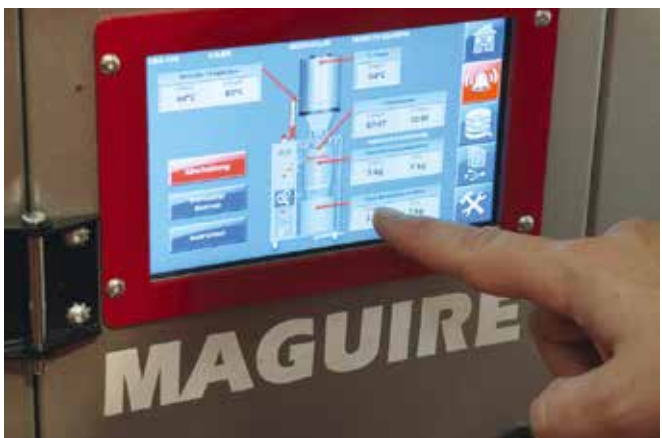
▲ Die Einstellung der Vakuumtrockner erfolgt an einem übersichtlichen Touchscreen. Wichtige Prozessinformationen, wie etwa Durchsatz und Energieverbrauch, sind jederzeit verfügbar.
