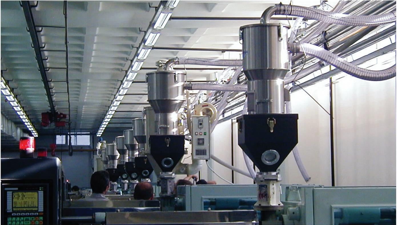
Vakuumbehälter Typ SVR und isolierte Materialbehälter
