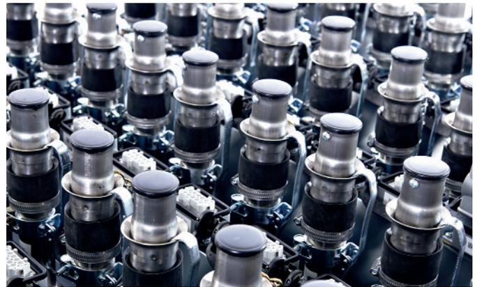
Vakuumabscheider Typ SVR und isolierte Materialbehälter
