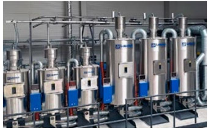
Ein Gravimetrischer Trocknungsbehälter überwacht das Befüllen und Entleeren der Kunststoff-Rohmaterialien nach dem „Gain-in-Weight“ und „Loss-in-Weight“-Prinzip, auf die energieeffizienteste Weise. Das System verwendet nur die Energie, die für den tatsächlichen Materialtyp und Verbrauch benötigt wird – keine überschüssige Energie.
