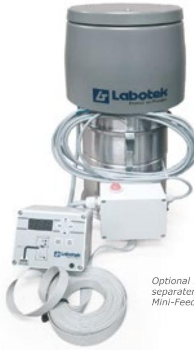
*Optional ist ein Kit zur separaten Steuerung von Mini-Feed 15-120 erhältlich.*
