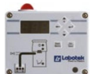
E2 – Motorfehler (z. B. Bürsten\*,Kabelverbindungen): Auch hier erfolgt eine Anzeige im Display, die Alarmleuchte (Option) aktiviert sich, und die Maschine schaltet ab.
