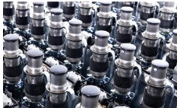
Kupplungsbahnhof mit Schnellkupplungen und optionalem Überwachungssystem
